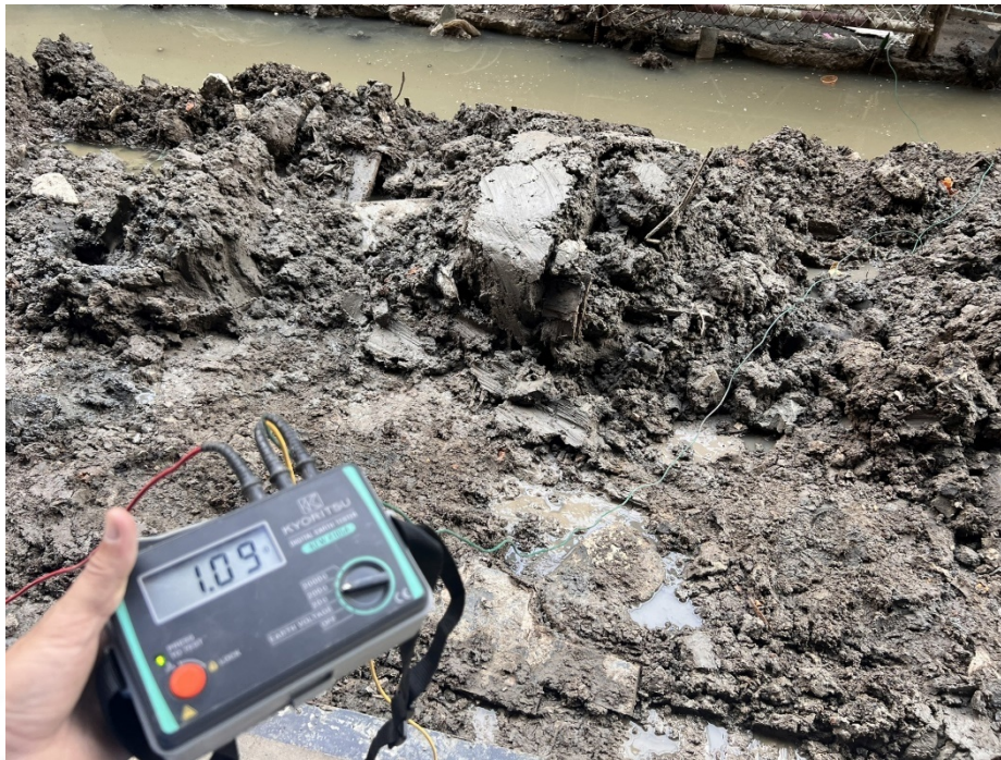
ภาพที่ ๒.๗.๔ การวัดค่าความต้านทานไฟฟ้าของระบบป้องกันฟ้าผ่า
