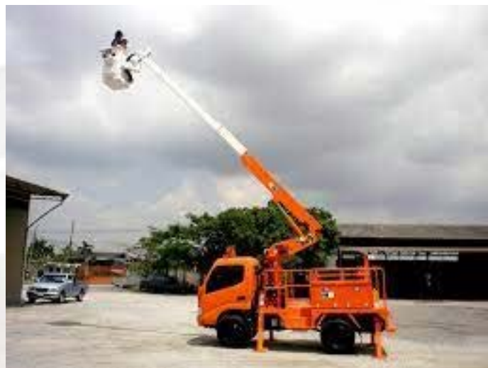
รูปภาพที่ ๙ แสดงตัวอย่างการใช้เครื่องจักรสำหรับใช้ในการยกคนขึ้นทำงานบนที่สูง
