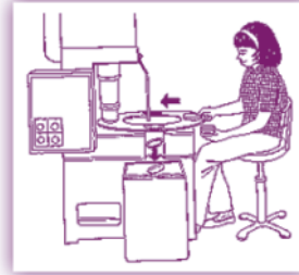
เครื่องป้อนโลหะที่มีอุปกรณ์ป้องกันแบบจานหมุน
