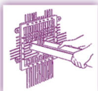
การ์ดที่สามารถปรับได้ สำหรับเครื่องป้อนโลหะ
