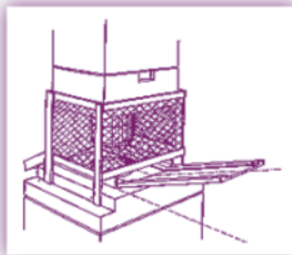
เครื่องป้อนโลหะที่มี รางลาดเอียงป้อน ชิ้นงาน
