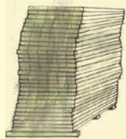
1 หมอนและเสาโลหะช่วยในการจัดเรียงซ้อนไม้ให้อยู่ในแนวตั้ง
