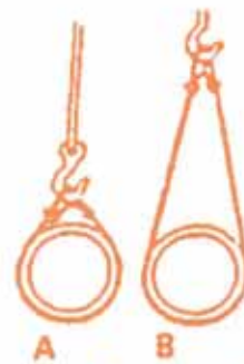
การพันสลิงรูป A ถูกต้อง รูป B อาจทำให้ท่อเลื่อนได้ ควรใช้เฉพาะกรณียกท่อหนักมาก เท่านั้น
