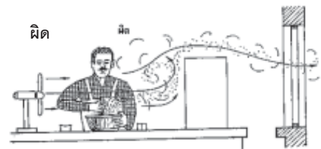
ใช้พัดลมเพื่อขจัดมลพิษในอากาศ
