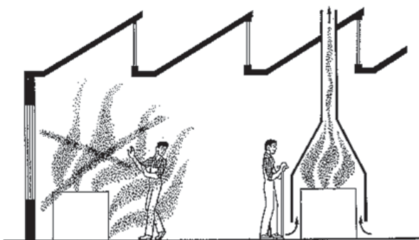
การใช้ฉากดูดซับความร้อน เพื่อปิดกั้นรังสีความร้อน
