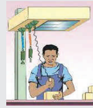
การจัดให้มีกรอบโครงเหนือศีรษะที่สร้างขึ้นเป็นพิเศษ สำหรับแขวนเครื่องมือด้วยสปริง
